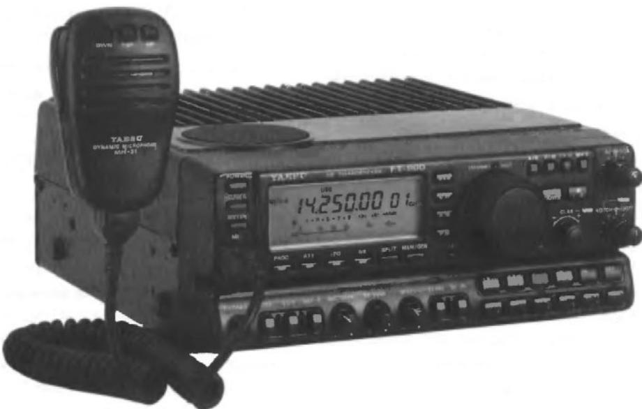
FT-900 новый высокоэффективный трансивер, обеспечивает до 100 Вт Выходной мощности передатчика на всех КВ радиолюбительских диапазонах в CW, SSB и FM режимах, и до 25 Вт несущей в АМ. Приемник работает на всех частотах от 100 кГц до 30 МГц, с шагом 2.5 Гц.
