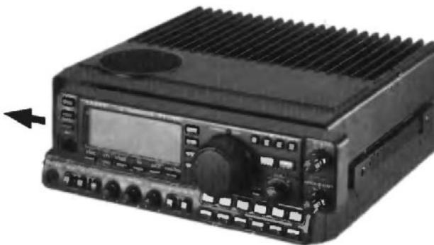
Установка Съемной Передней Панели
